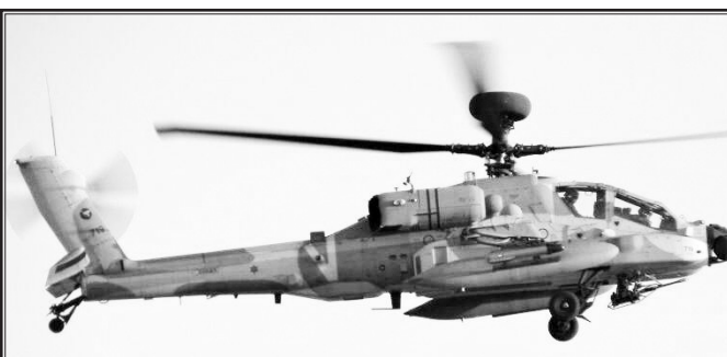
بالگرد آپاچی لانگبو مدل D ارتش رژیم صهیونیستی - به اواخر نصب شده در بالای پره‌های اصلی دقت کنید
